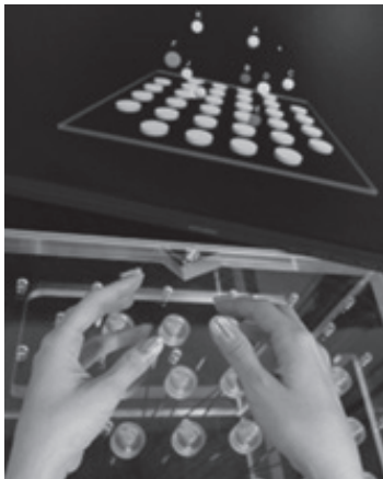
図1 新しい磁気式3次元モーションセンサ *口絵にカラー版掲載
